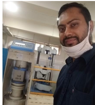
(d) Testing of cube under CTM
