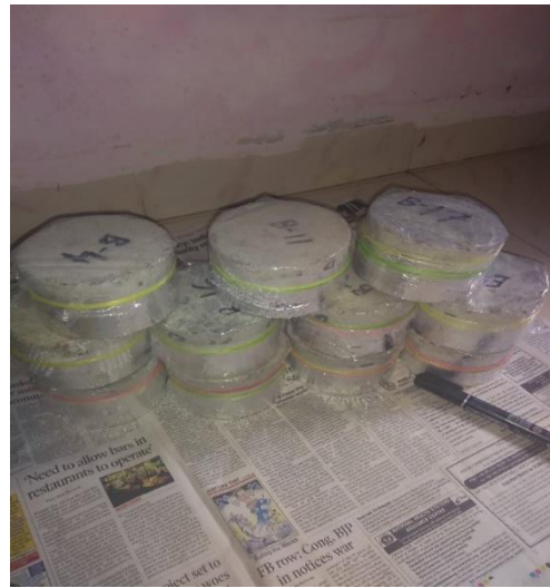
(d) side and top sealing of specimen
