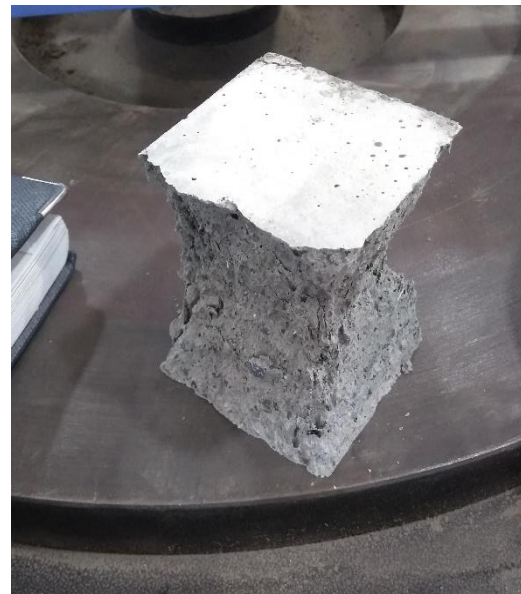
(d) Cube after compressive strength test
