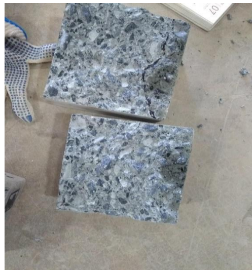
(d) measurement of penetration depth
