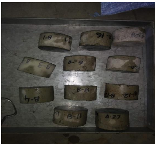
(d) saturated specimen after boiling
